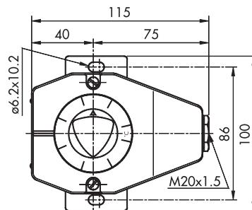
**Fühler- und Schutzrohrmontage / Montage de la sonde et du doigt de gant / Mounting of sensor and protection tube**
